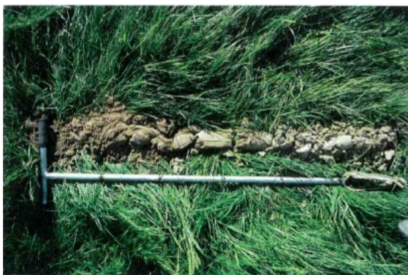
Figure 36 : Sondage secteur nord-ouest : argile sur 1 m (source : Geoarmor, 2011)
