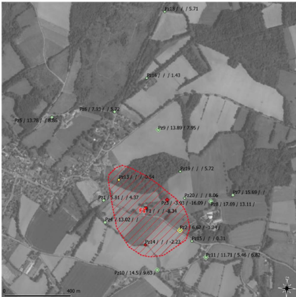
Figure 22 : Rabattements maximaux (mesurés ou estimés) et délimitation de la zone sensible (Calligée, 2022)
