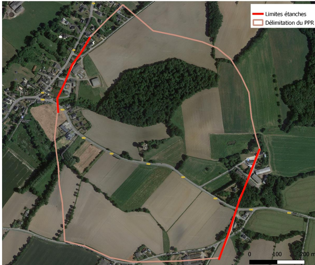
Figure 24 : Limite du PPR définie à partir des limites étanches, du rabattement de 3 m observé en 2009, et des charges piézométriques mesurées en pompage montrant une influence du pompage jusqu'à la route au Sud
