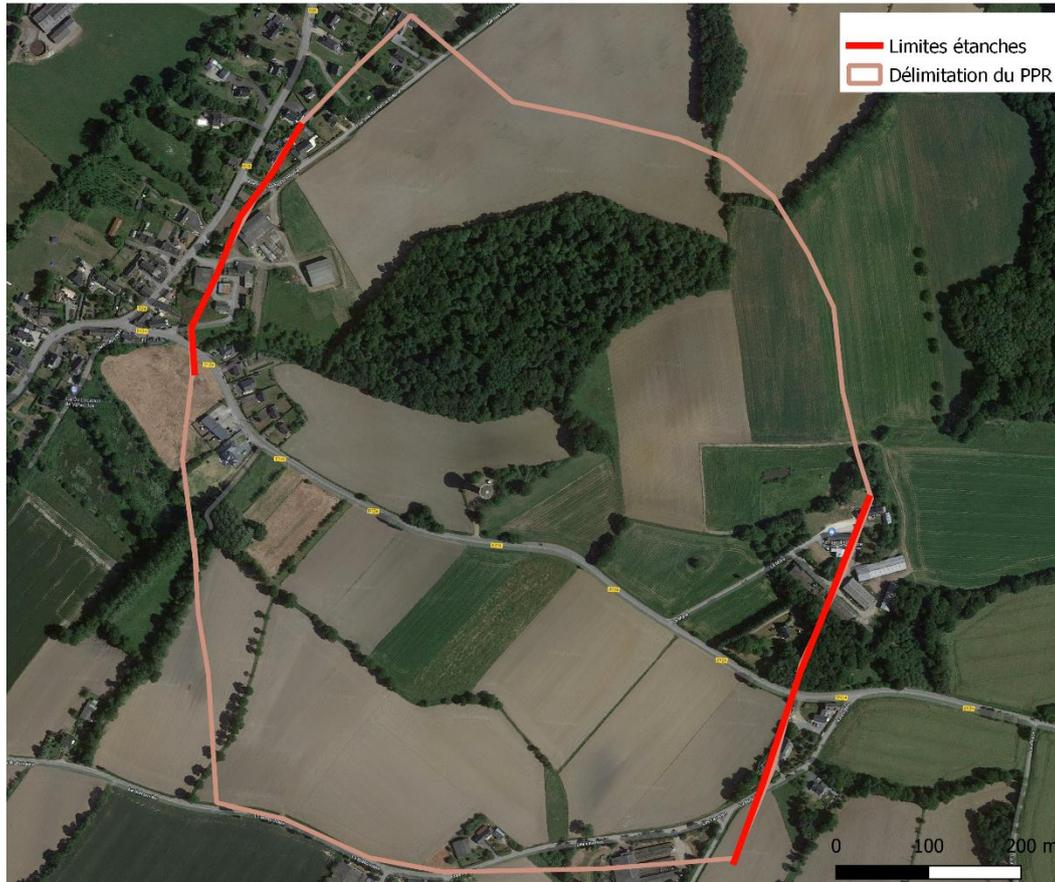
Figure 24 : Limite du PPR définie à partir des limites étanches, du rabattement de 3 m observé en 2009, et des charges piézométriques mesurées en pompage montrant une influence du pompage jusqu'à la route au Sud
