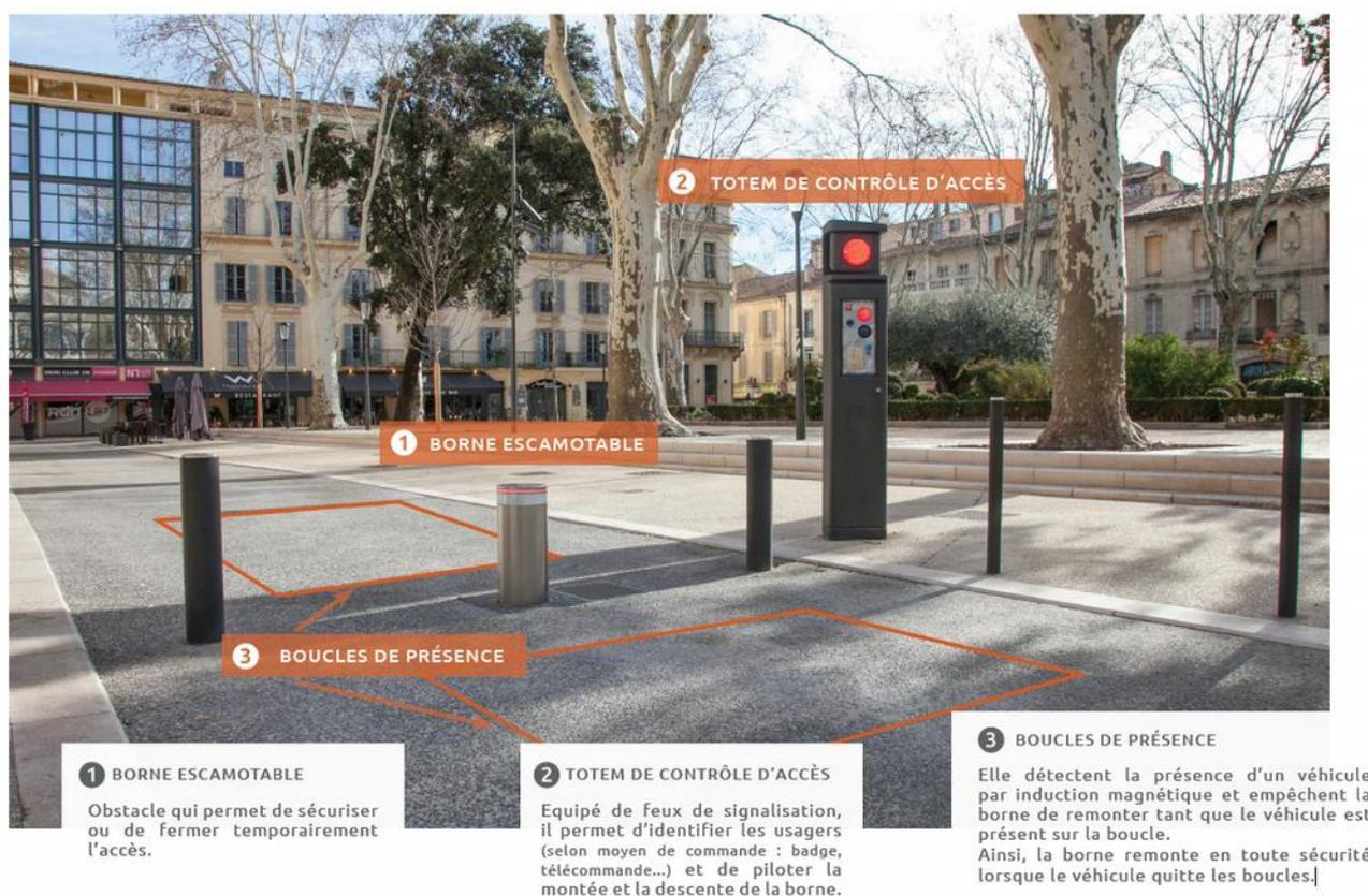
Illustration 41: Caractéristiques technique d'une borne escamotable. Source : BES
